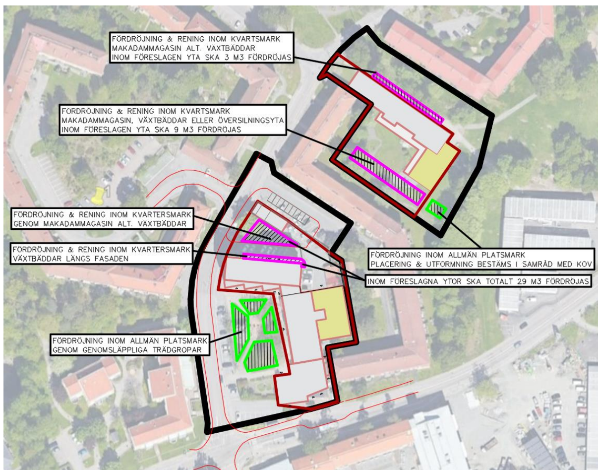
Figur 12. Föreslagna åtgärder inom planområdet. Kvartersmark begränsas med tjock heldragen röd linje. Yta mellan svart och röd linje redovisar allmän platsmark. Skrafferade ytor föreslår placering av dagvattenanläggningar.
