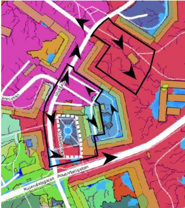
Figur 8. Delavrinningsområden och ytliga rinnvägar inom och i angränsning till planområdet. Färgerna skildrar olika avrinningsområden. Pilarna visar ytliga rinnvägarna och svarta polygonerna planområdet.
