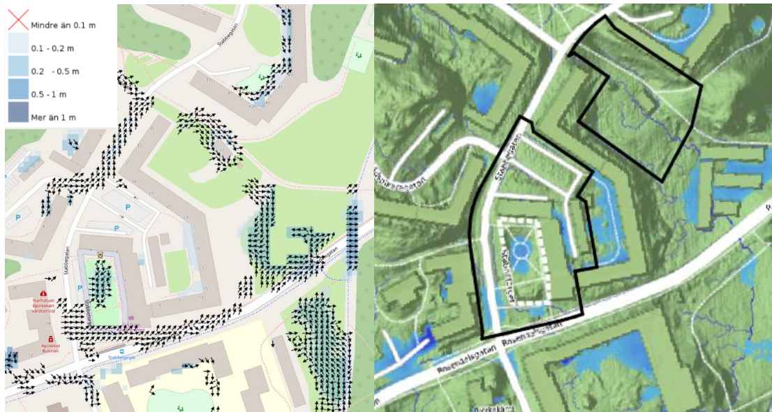
Figur 10. Vänstra bilden: Resultat från skyfallsmodellering. Blå områden visar var det samlas vatten vid skyfall. Mörkare blå färg innebär större vattendjup. Pilar visar flödesriktning på ytavrinningen. Högra bilden: Resultat från Scalgo. Ungefärligt planområde visas med svart linje. Grön yta avser topografi samt byggnader och blå yta visar var det bildas vattenansamlingar.
