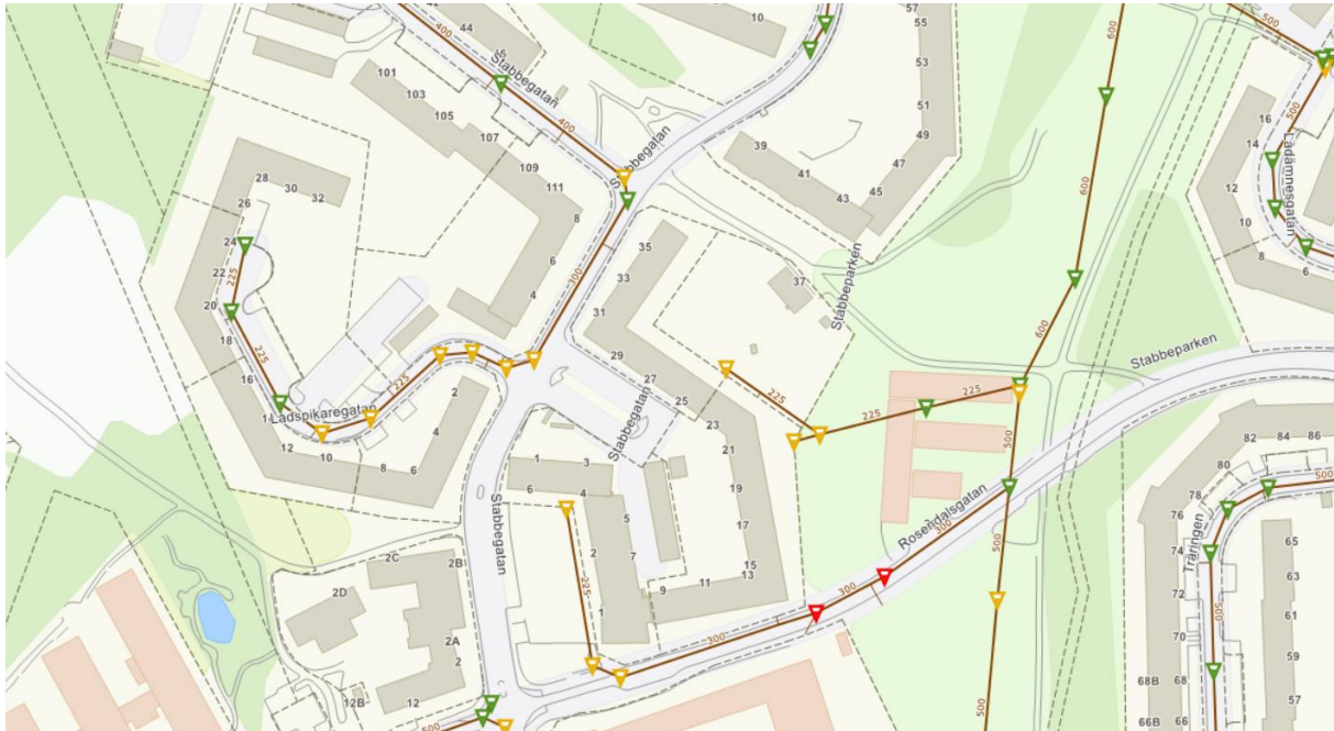
Figur 9. Maximal vattennivå i ledningsnätet relativt marknivå/ledningshjussa vid dimensionerande 10-årsregn med klimatfaktor 1,25 (Kretslopp och vatten, 2021).
